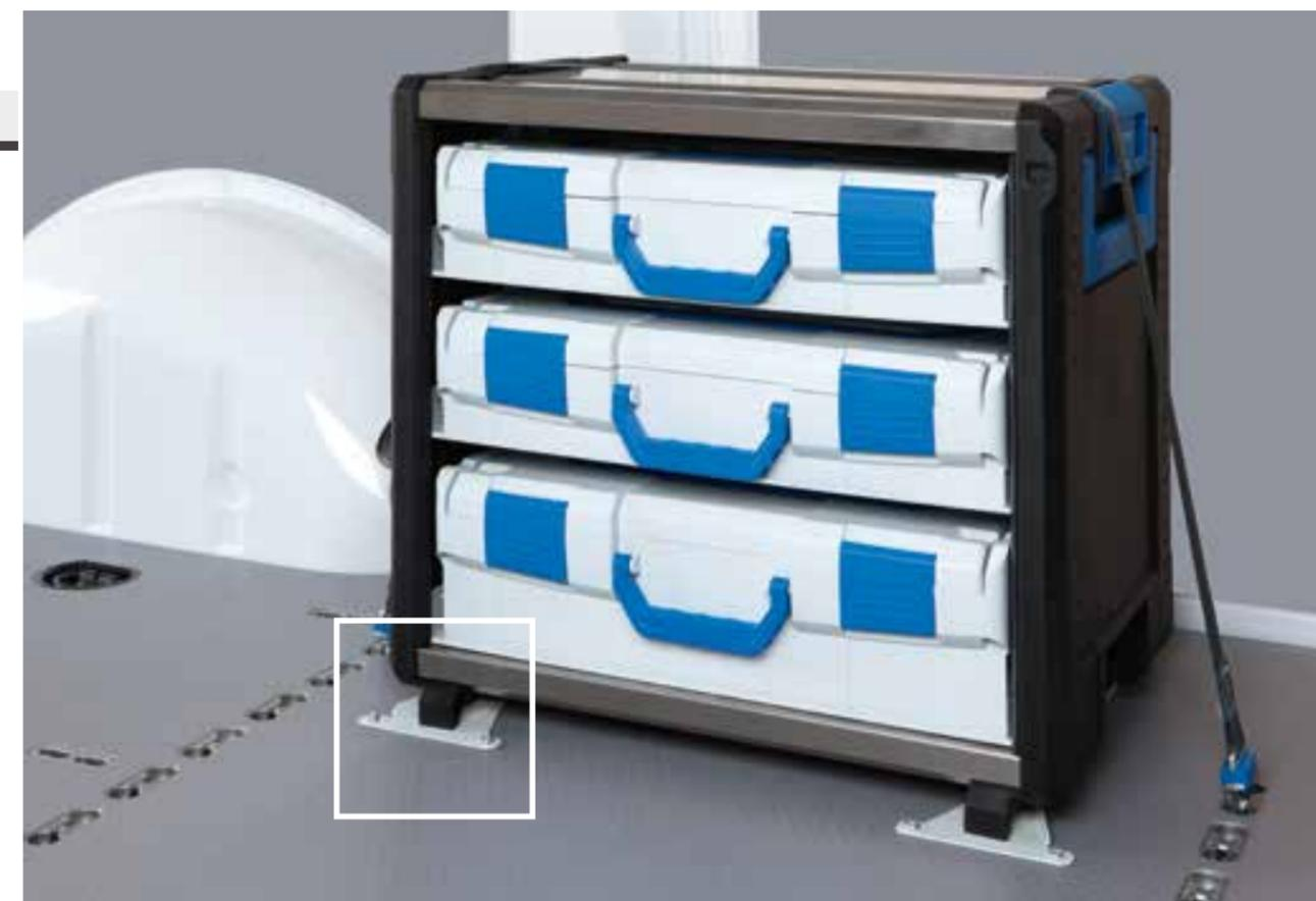
Les rails sont vissés sur le sol du véhicule et servent ainsi à **maintenir la position du WorkMo**. Ils sont montés dans le sens contraire de la marche ou transversalement pour intercepter les forces de freinage. Une sangle supplémentaire est nécessaire pour la sécurisation du chargement.
