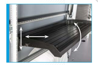
La tablette peut être repliée contre la paroi du véhicule et son inclinaison peut être ajustée.
