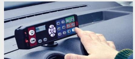
Le boîtier de commande permet de sélectionner le message (multilingue) requis pour s'adapter rapidement à toute situation.
