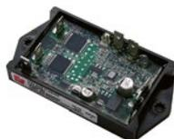
Centrale clignotante - 2 canaux - 10A - 2 modes de clignotement présélectionnés - choix de 8 fréquences de clignotements - sorties (+) - commande (+)
