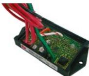
Centrale clignotante Intelli-Flash pour applications à Leds - 8 Fréquences - 2 x 6A - commandes négatives
