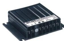
Centrale clignotante (SFC100) - 2x2 sorties - 60/120 Eclats/min - 2 x 12A/sortie - Pour applications à LED et à halogène
