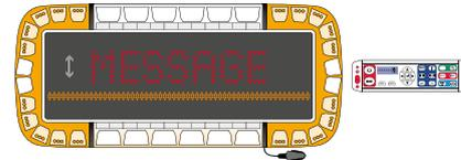
20 modules Orange - double panneaux à message variable rabattable (message vers l'avant - texte rouge - message vers l'arrière - texte rouge - défilement orange) - Connecteur de toit CT19 - Kit de fixation - boîtier de commande BCT3000 inclus
