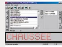
Logiciel 'SmartSign Message Editor' pour l'édition et téléchargement des 200 messages programmables - compatible avec Windows - câble RJ-45
