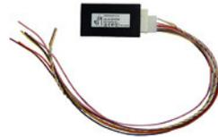
Permet l'activation automatique de rappel clignoteurs ou des feux additionnels bleus dans le hayon par l'ouverture du hayon
