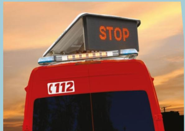
Avec la TACTIC montée sur un véhicule d'assistance à la circulation, il n'est plus nécessaire de déployer deux véhicules sur le lieu d'un incident pour rediriger le trafic. Un seul véhicule suffit. Le panneau est orienté en direction du trafic arrivant pour le rediriger et créer une zone de sécurité. La signalisation intégrée dans la rampe de base renforce la visibilité et alerte le trafic du danger.
