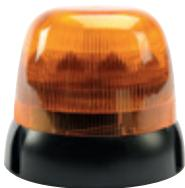
Feu à 11 LED Solaris compact - "Short" coiffe basse - Orange - 580gr - 0.49A@12V - 0.29A@24V - 120FPM - Montage permanent - Uniquement en flashing
