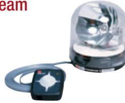
Phare chercheur omnidirectionnel VB12S1 - 100W - orientable 360° - 110° vers le haut - 35° vers le bas - commande à distance avec câble de 5m - montage permanent
