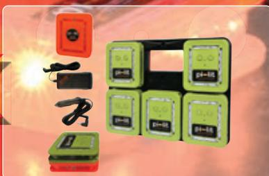
Système à modules à LEDs - 5 Modules - vert et infrarouge - Base magnétique - Synchronisation automatisée - Chargeur et support en 1 - Module équipé d'accumulateur rechargeable - Chaque kit comprends des bases ballastées qui empêchent les modules de se déplacer/s'envoler à cause de la turbulence d'air causé par le rotor.
