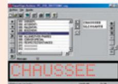
Logiciel 'SmartSign Message Editor II' pour l'édition et téléchargement des 200 messages programmables - compatible avec Windows - câble RJ-45
