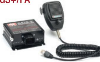
Amplificateur de sirène - 100W - 21 tonalités - Fonctions nuit et vibrato - Fonction klaxon - Fonctionne en 10-30VDC - Avec PA/micro - Configurable via Console Express - Consommation au repos: 30 à 50 mA
